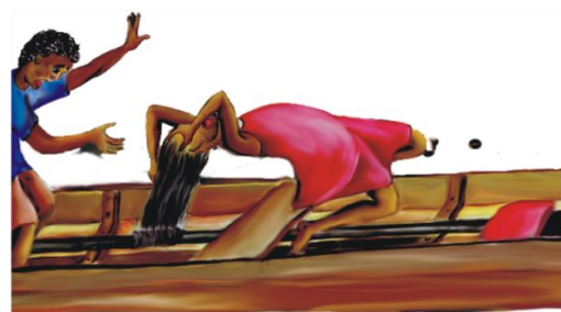
Fig. 2 Cabelos enroscados no eixo das embarcações provocam escarpelamento
