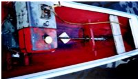
Fig. 1 Embarcação típica da região Amazônica com eixo do motor descoberto
