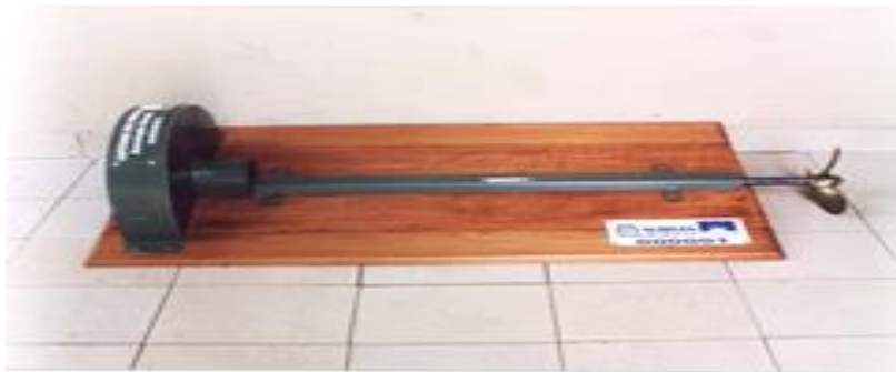
Fig. 3. Dispositivo de proteção do eixo do motor das embarcações
